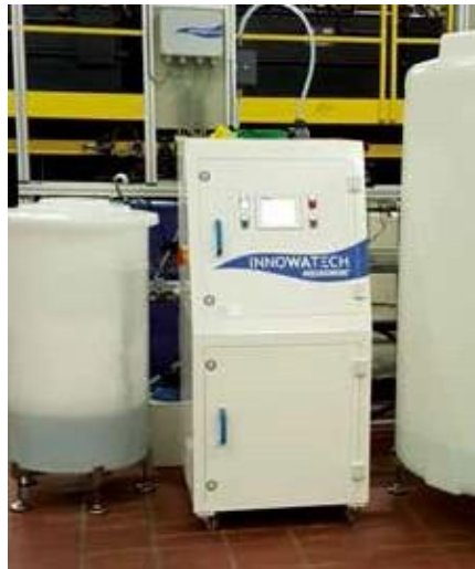
Izquierda: Aquadron® PGK con depósito de sal en pellets (tanque pequeño) y tanque de suministro de Anolyte (tanque grande en la pág. 26) para el tratamiento de líquidos refrigerantes. Anolyte con pH neutro es producido en cédas con membranas para electrolisis de INNOWATECH (a la derecha).
