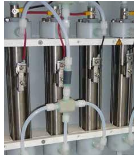
Izquierda: Aquadron® PGK con depósito de sal en pellets (tanque pequeño) y tanque de suministro de Anolyte (tanque grande en la pág. 26) para el tratamiento de líquidos refrigerantes. Anolyte con pH neutro es producido en cédas con membranas para electrolisis de INNOWATECH (a la derecha).
