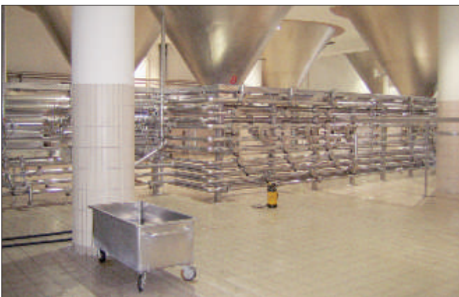
Abb. links: Zylindrokonische Lagertanks mit Leitungssystem bei der Stieglbrauerei – Desinfektion über CIP mit „Innowatech Anolyte“ – Abb. rechts: CIP-Desinfektionstank mit „Innowatech Anolyte“ bei der Stieglbrauerei Salzburg.
