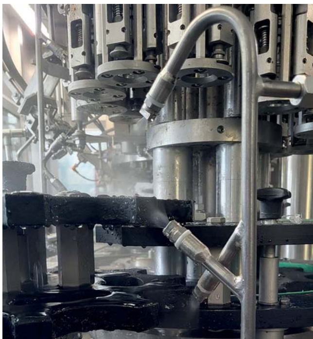
Ein ausgeklügeltes System an Sprühdüsen verbessert die Hygiene am Füller. © INNOWATECH
