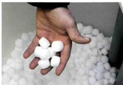
A partir de sal en pellets y agua potable, es producido el agente desinfectante Anolyte (Fotos: Innowatech)
