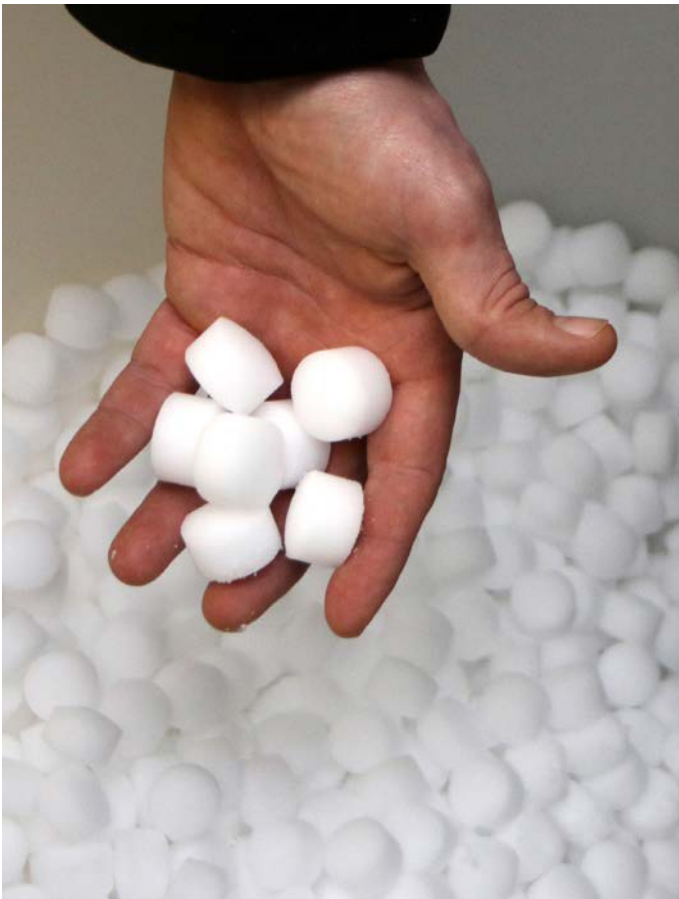
Abb. 3: Aus Salztabletten und Trinkwasser wird Anolyte produziert.
