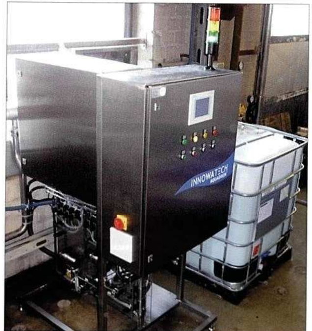
Abbildung 1: Aquadron® SG2 zur Produktion von Anolyte mit geringem Chloridgehalt
