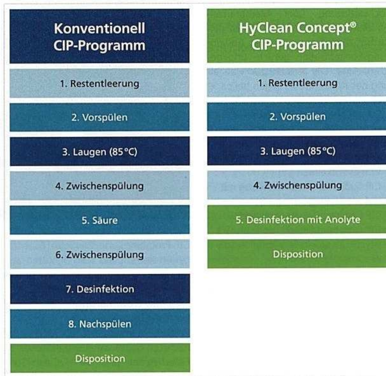
Abbildung 3: Vergleich von Hygiene-Optimierungen im Abfüllprozess
